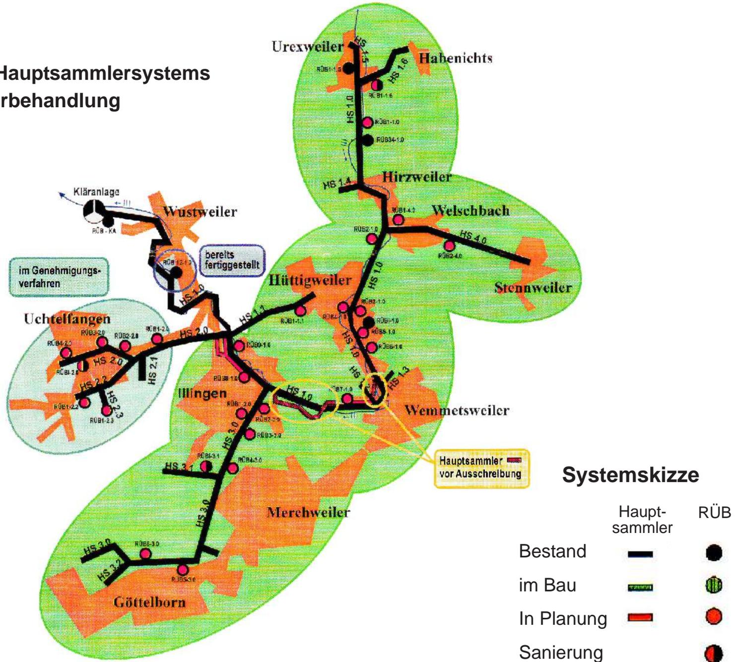
Überprüfung der Optimierungsberechnung der Regenwasserentlastungsanlagen
