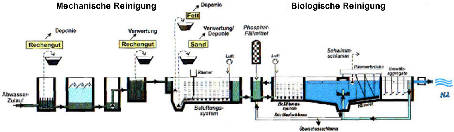
Grobrechen   RUB   Zulauf-pumpwerk   Sieb-anlage   belüfteter Sand- und Fettfang   Verteiler-schacht   2 Kombibecken (Belebungs und Nachklärung)
